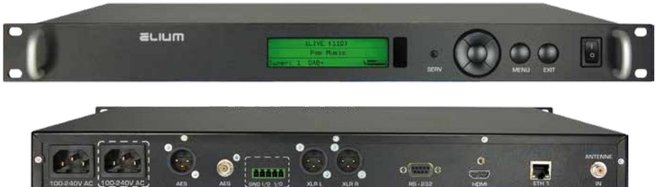
Der **IRD 3040** ist ein professioneller bidirektionaler Audio Decoder mit exzellenten **DAB / DAB+**, sowie **FM Radioempfangseigenschaften**. Dieses Gerät ist für den Broadcast-Bereich konzipiert und verfügt neben XLR-Schnittstellen auch über AES-Ausgabeoptionen.
